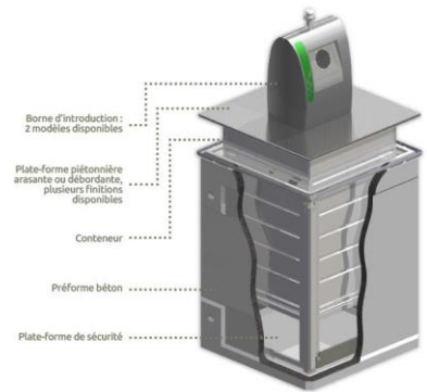
Principe de conteneur enterré Site Internet Astech ( www.astech-eco.com/ conteneurs-enterrés )
